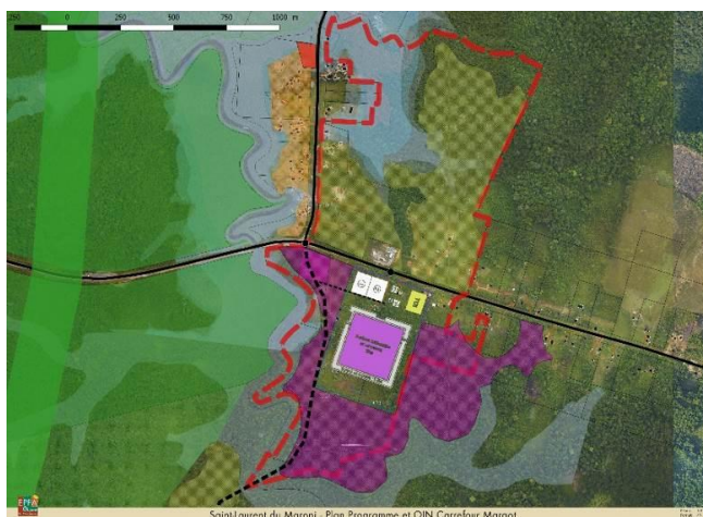
Figure 13 - Évitement par décalage du tracé et aménagement d'un carrefour à 5 branches concentrant desserte et échanges
