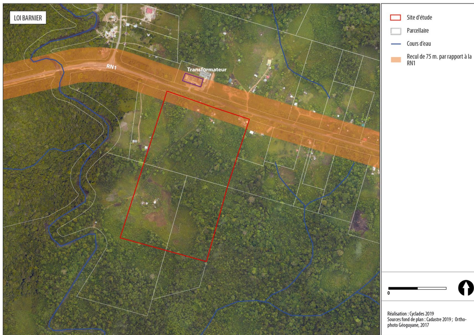
Figure 102 : Application de la loi Barnier autour de la RN1 (recul de 75 m par rapport à l'axe de la RN1)
