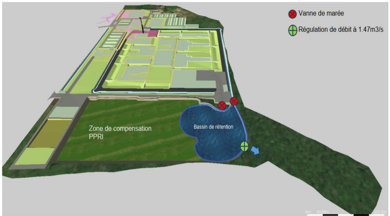
Figure 43. Localisation de la zone de rejet et des vannes de marée
