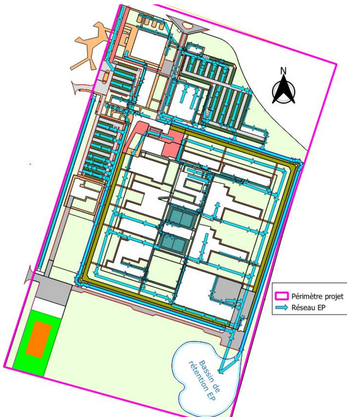
Figure 20. Plan de principe du réseau EP
