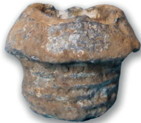
Fig.64 Tr. 19, Iso 88 : adaptateur de pas de vis pour fusée 24/31 et assemblage pyrotechnique d'une fusée française 24/31 : de gauche à droite, le corps de fusée 1), un adaptateur de pas de vis (2), le petit détonateur à visser à la base de la fusée (4) et la gaine-relais à insérer dans la tête de l'obus (5).
