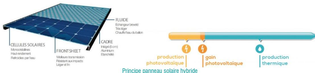
Cette solution nécessite plus de surface pour atteindre la même production que le solaire thermique classique, mais elle a l'avantage de produire de l'électricité en parallèle.
