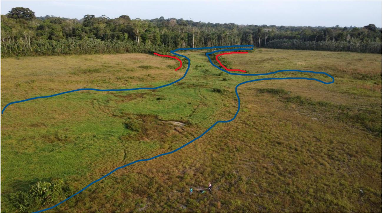
Figure 1 : Vue par drone réalisée par ANTEA de la zone humide (en bleu). Le tracé rouge marque la présence de terres et grumes mis en andains lors de la défriche renforçant ainsi l'effet cuvette (Photo : ANTEA)
